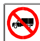
SR-32 Prohibido el paso a vehículos pesados
