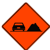
Material en la vía DPP-1
