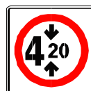
SR-15 Altura libre restringida
